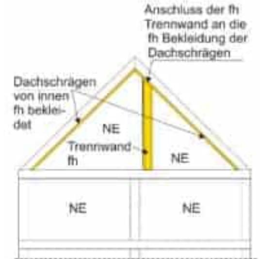
**Empfehlung:** satte Ausmörtelung oder Hohlraum oberhalb der Trennwand bis zur Dachplatte mit nichtbrennbarer\*, raumbeständiger Dämmung Schmelzpunkt  $\geq 1.000$  °C hohlraumfrei ausfüllen
