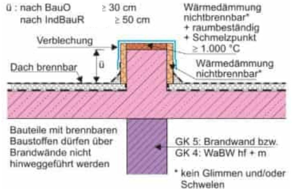
Wärmedämmung auf einer Breite von mind. 1,0 m beidseits der BW bzw. WaBW nichtbrennbar\*, raumbeständig, druckbelastbar und Schmelzpunkt  $\geq 1.000$  °C
